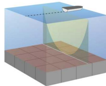
В обычных датчиках используются конусообразные лучи. Для сканирующего сонара Garmin ClearVü предусмотрено использование двух узких лучей, схожих по форме с лучом копировального аппарата. Эти лучи обеспечивают более четкое, напоминающее фотографию изображение пространства под судном.
